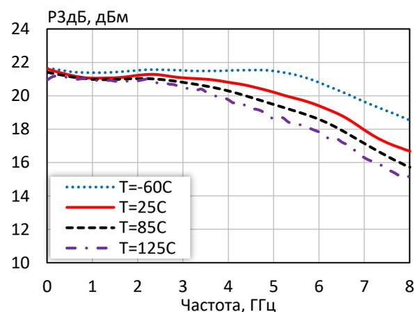
Точка пересечения интермодуляции третьего порядка по выходу при различной температуре ( $I_p = 100\text{ mA}$ )
